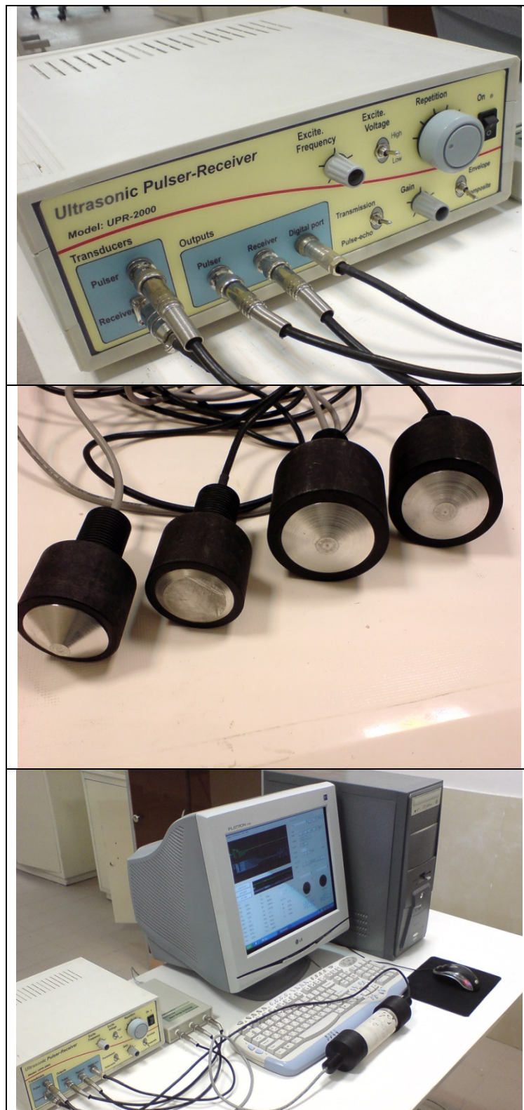
شکل ۲. تصاویری از دستگاه فراصوتی و مبدل‌های مورد استفاده در آزمایش‌ها.
