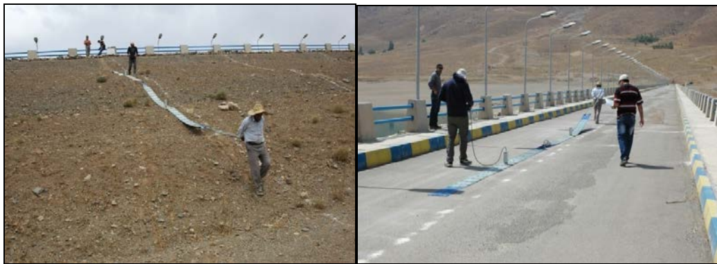
شکل ۶. نمایی از برداشت پروفیل‌های رادار نفوذی (الف) بر روی محور و (ب) سطح شیبدار پایین دست سد خوانسار.
