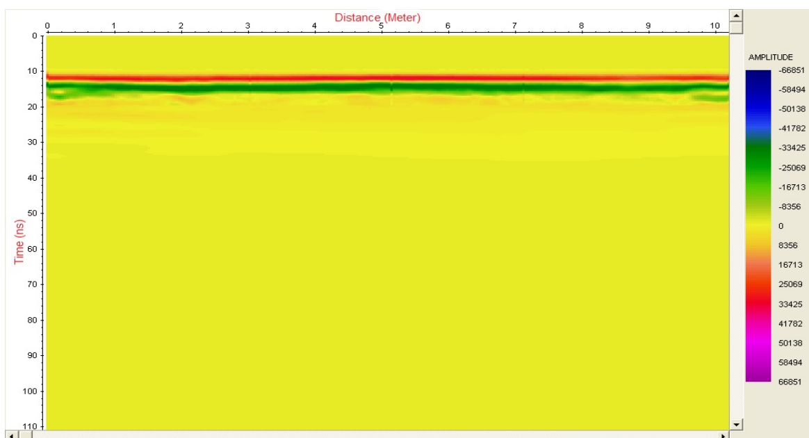
شکل ۴. مقطع اولیه به‌دست‌آمده از برداشت داده‌های ژئورادار با آنتن ۲۵۰ مگاهرتز.
