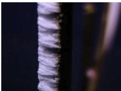
شکل ۷. برفکی شدن یکی از میله‌های برنجی در اثر چرخش در محیطی که قطره‌های آب‌سرد وجود دارند.
