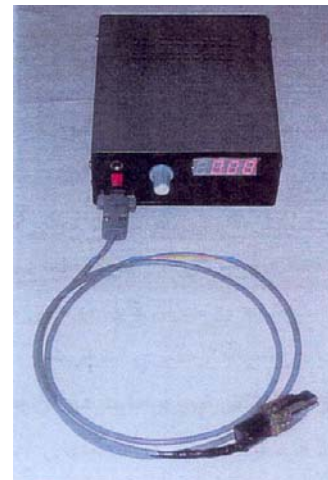
تصویر ۱: دستگاه اندازه‌گیری نیروی بایت
