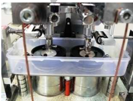
شکل ۴. قرارگیری هم‌زمان ۲ نمونه در دستگاه سایش
