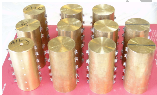
شکل ۱. نمونه‌های باکال تیوب فلزی باند شده به سطح آمالگام آماده سازی شده با کمک سه رزین حد واسط
