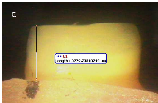
شکل ۱: ارتفاع دندان‌ها قبل (الف) و بعد از ۱۰۰۰ (ب) و ۲۰۰۰ (ج) دور سایش در زیر میکروسکوپ نوری (بر حسب میکرومتر).
