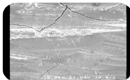
شکل ۲. نمای سطح زیرکونیا پس از تابش با لیزر CO 2 با بزرگ‌نمایی ۱۰۰۰x (سطحی خشن با ظاهری فلس مانند به همراه میکروتِرک)
