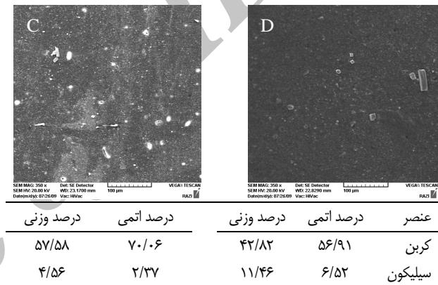
شکل ۱. نمای میکروسکوپ الکترونی روبشی با بزرگنمایی ۳۵۰ و مقادیر سطحی جیوه و نقره آمالگام Colten (C) و عناصر کربن (D) در نمونه‌های ریباند شده سیلیکون (Si) با بلیچینگ
