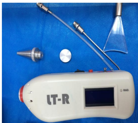
شکل ۱: دستگاه لیزر کم توان ۶۶۰ نانومتر مورد استفاده در بالای سمت چپ تصویر سری مورد استفاده در کانال گوش خارجی می‌باشد.
