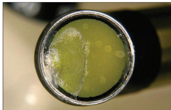
شکل ۱: آلودگی سر دستگاه میزان انرژی رسیده را کاهش می‌دهد (۲۴)
