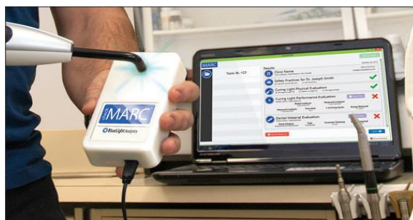
شکل ۲: دستگاه Check MARC برای بررسی تابش دستگاه لایت کیور
