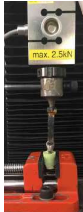
شکل ۳: اتصال به دستگاه تست کننده یونیورسال جهت ایجاد کشش
