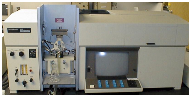
شکل ۴. دستگاه جذب اتمی تولید هیدرید جهت آنالیز نمونه‌ها
