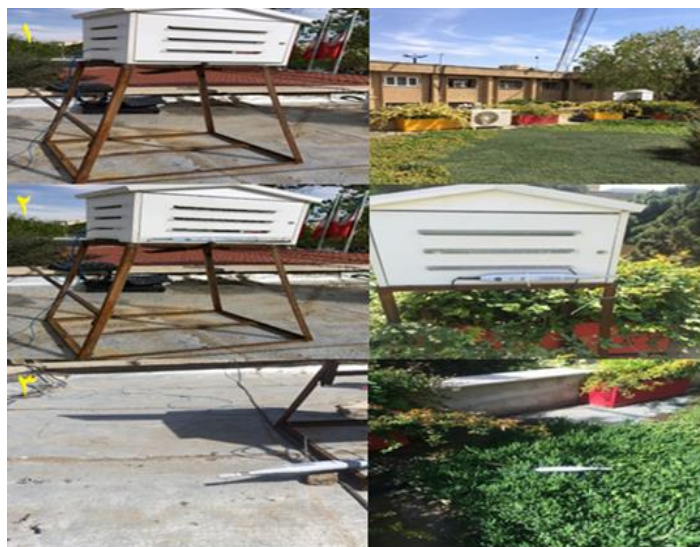
شکل ۲. نحوه نصب دیتالاگرها در وضعیت‌های اندازه‌گیری (۱ تا ۳) (سمت راست: بام سبز؛ سمت چپ: بام مرجع)
