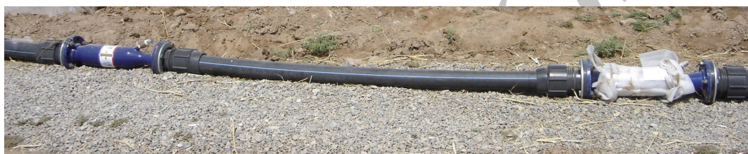
شکل 1- روش قراردادن دستگاه مغناطیس مورد استفاده در مسیر آب
