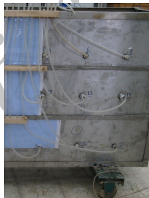
شکل ۲- نمایی از لوله‌های پیرومتر
