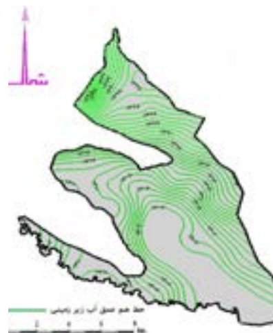
شکل ۸ - نقشه شبیه‌سازی شده خطوط هم‌عمق آب زیرزمینی در فروردین ۱۳۸۷ در مرحله صحت‌سنجی شکل ۹ - مقایسه داده‌های مشاهداتی و محاسبه شده در پیزومترهای میان-دریغ در فروردین سال ۱۳۸۷ در مرحله صحت‌سنجی
