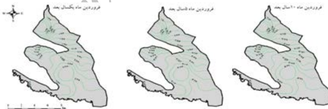
شکل ۱۲ - میزان افزایش بارآبی در فروردین یک، پنج و ۱۰ سال پس از اجرای طرح آبیاری و زهکشی گاوشان
