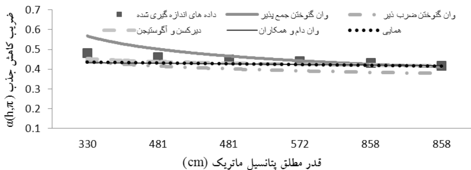
شکل ۱۴- برازش مدل‌های مختلف برداده‌های اندازه‌گیری شده حاصل از تیمار سطح شوری ۶/۵ds/m و تخلیه ۵۰ درصد
