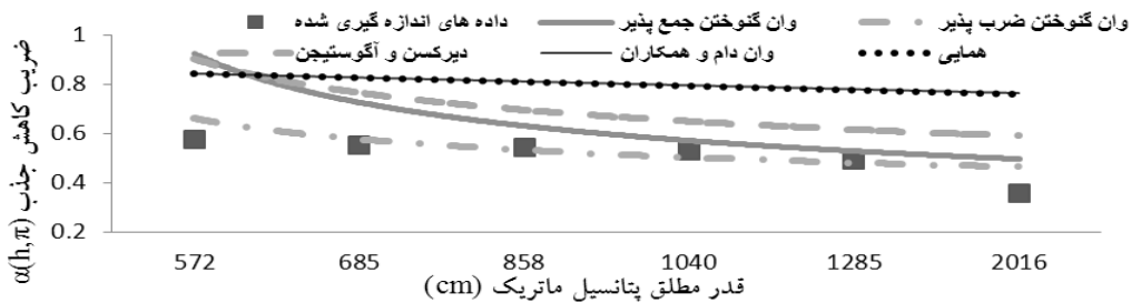
شکل ۸- برازش مدل‌های مختلف بر داده‌های اندازه‌گیری شده حاصل از تیمار سطح شوری ۲/۵ds/m و تخلیه ۵۰ درصد
