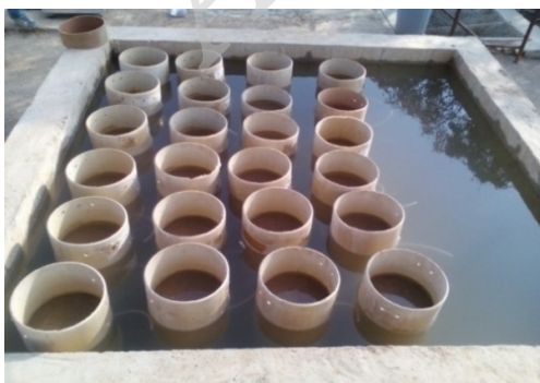
شکل ۱- اشباع کردن ستون‌های آزمایش از پایین
