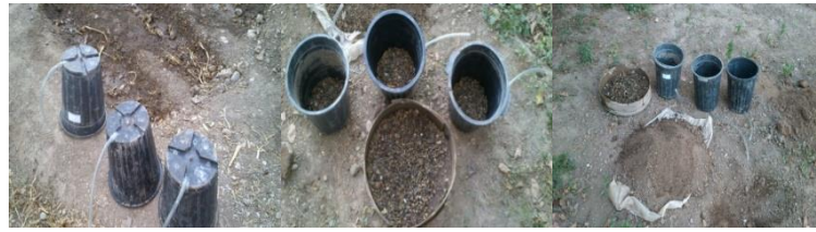
شکل ۱- مراحل ساخت و آماده‌سازی میکرو لایسیمتر وزنی- زهکش‌دار پیشنهادی
