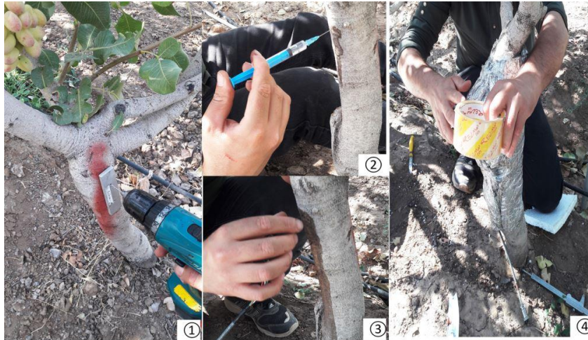
شکل ۲- مراحل نصب سنجده دستگاه اندازه‌گیری شیره آوندی
