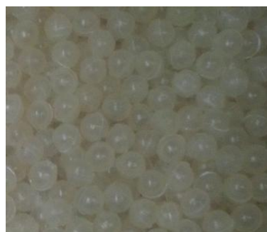
شکل ۷- تجمع رسوبات موجود در پساب در سطح فوقانی توپ‌های ریز
