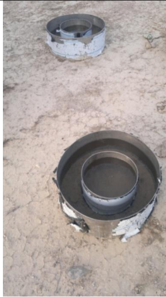
شکل ۵- اندازه‌گیری نفوذپذیری با استفاده از حلقه مضاعف
