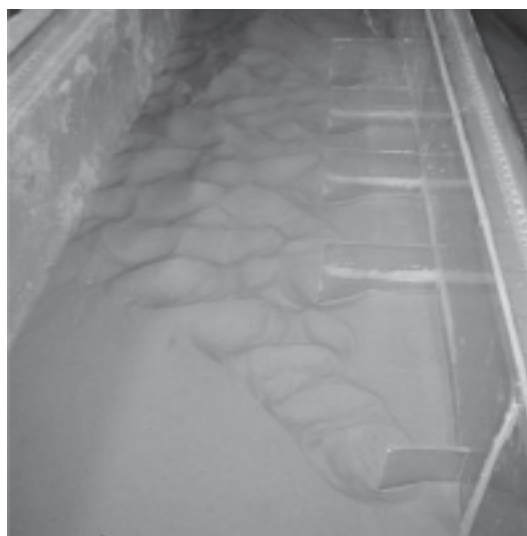
شکل ۷- آبستگي در دماغه اولین آبشکن و آبشکن فرعی
