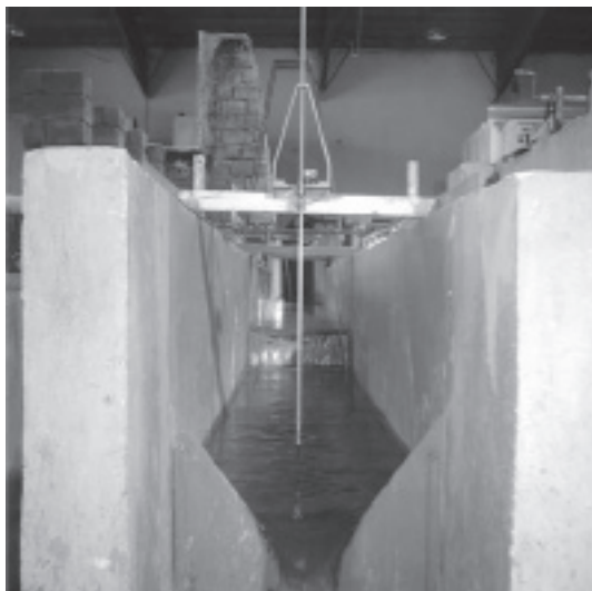
شکل ۲- سیستم کنترل و اندازه‌گیری دبی
