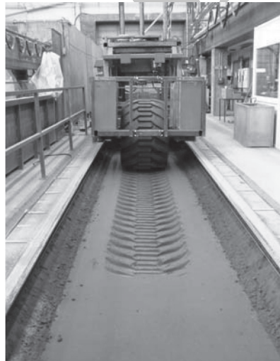
شکل ۲- خط اثر ایجاد شده با لاستیک نرم (راست) و حسگر نیمرخ فشردگی خاک (چپ)
