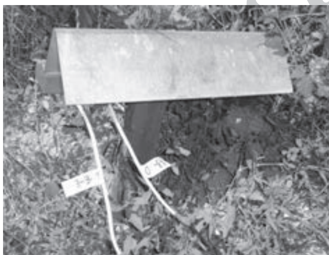
شکل ۹- استقرار حسگرهای اندازه گیری رطوبت خاک
