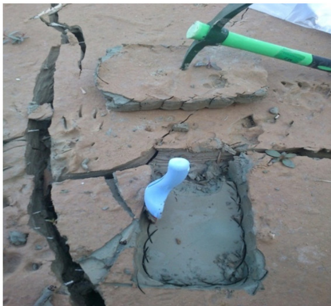
شکل ۴-نمایی از برداشت نمونه خاک در مخزن یک
