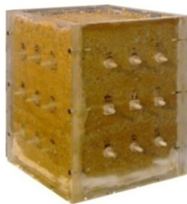
ج) نمونه‌ای از خاک متراکم شده در جعبه پلاستی شکل ۱- شماتیک و اجزاء مدل آزمایشگاهی ساخته شده
