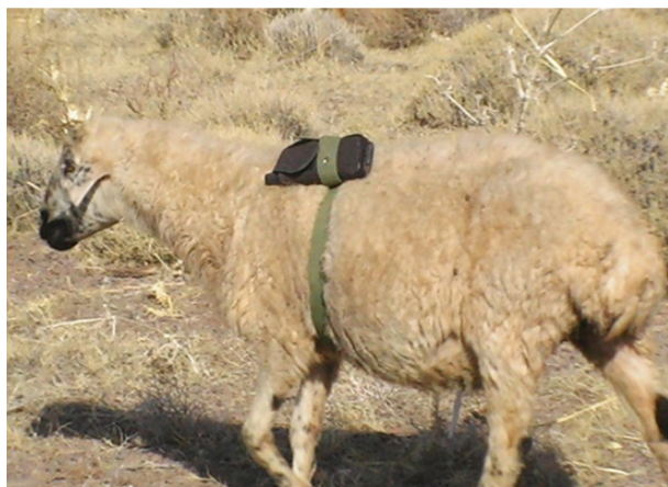
شکل ۲: دام انتخاب شده و نحوه بسته شدن دستگاه به گوسفند نژاد کرمان
