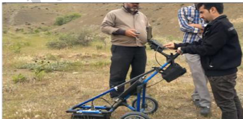
شکل ۳- برداشت داده با استفاده از دستگاه GPR
