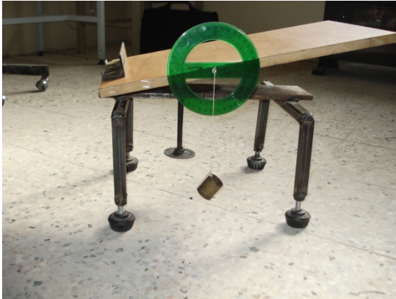
شکل ۱- سطح شیب دار بکار رفته برای اندازه گیری ضریب اصطکاک استاتیکی
