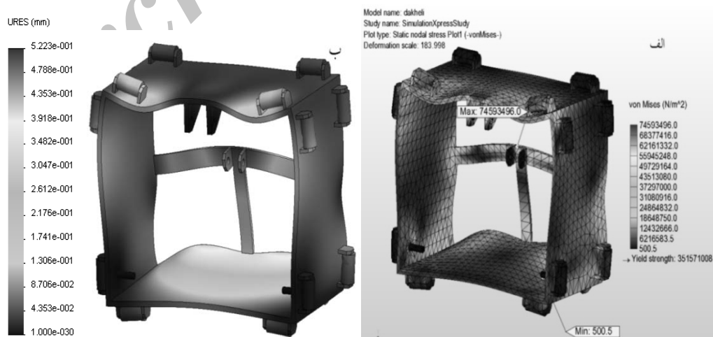
شکل ۴- تحلیل تنش (الف) و کرنش (ب) در قاب ۱ Fig4- stress (left) and strain (right) analysis of frame 1
