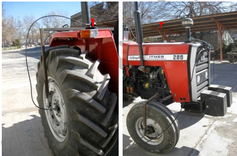
شکل ۲- استقرار انکودرهای چرخان بر روی تراکتور: (۱) محل نصب انکودرهای چرخ‌های عقب، (۲) محل نصب انکودرهای چرخ‌های جلو
