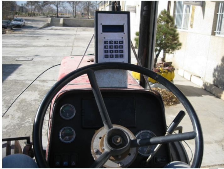
شکل ۱- نمایشگر سامانه و محل نصب آن بر روی داشبورد تراکتور
