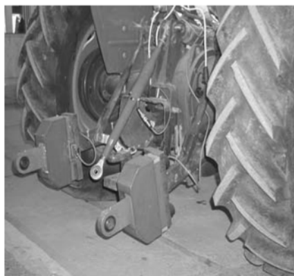
شکل 1- تراکتور مجهز به دینامومتر اتصال سه نقطه (راست) و دیتالاگر Campbell CR23X (چپ)
