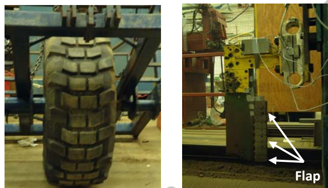
شکل ۱- حسگر نیمرخ فشردگی خاک (راست) و لاستیک سخت (چپ) Fig.1. Soil compaction profile sensor (right) and stiff tyre (left)
