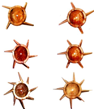
شکل ۱- صفحات دوار ساخته شده ۴، ۶ و ۸ پره: پره شعاعی (راست) و پره غیر شعاعی (چپ)
