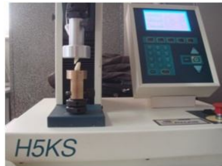
شکل ۲ - تست فشار بر روی نمونه‌های استوانه‌ای میوه سیب Fig.2. Compression test on cylindrical samples of apple fruit
