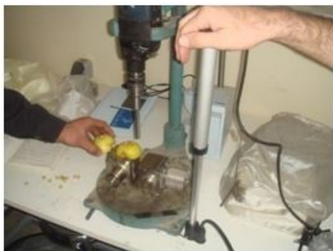
شکل ۱- روش تهیه نمونه‌ها برای تعیین خواص مکانیکی
