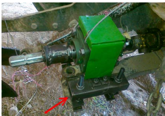
شکل ۶- اتصال گشتاورسنج به مالبند تراکتور
