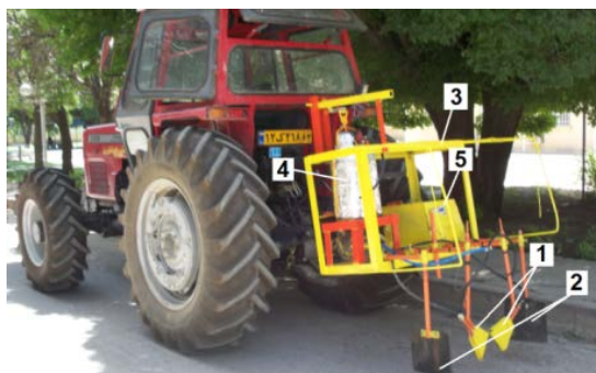
شکل ۱- نمایی از دستگاه شعله افکن نرخ متغیر سوار بر تراکتور:
