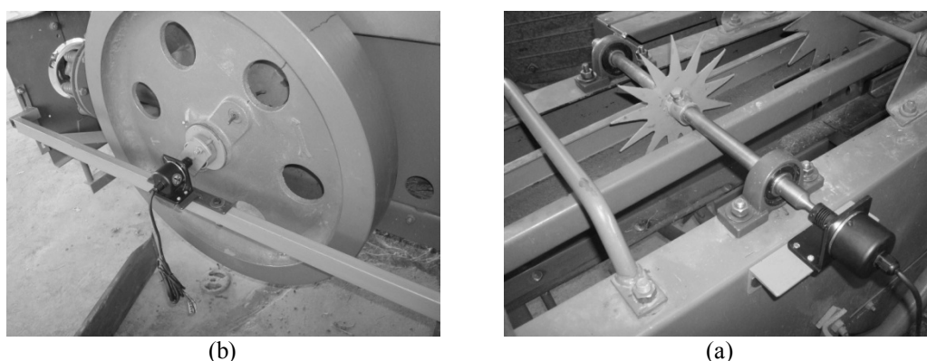
شکل ۳- سامانه‌های اندازه‌گیری؛ (a) ضخامت لایه افزوده در هر مرحله پرس، (b) سرعت خطی پلانجر
