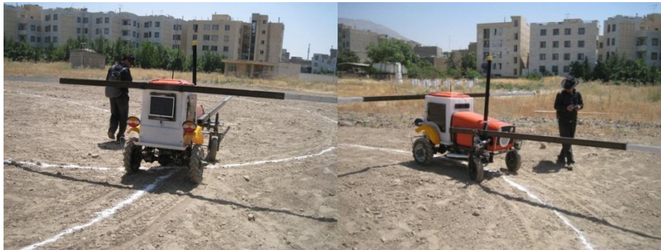
شکل ۱- دو تصویر از روبات در حال حرکت بر روی مسیر رسم شده بر روی خاک هموار، برای ارزیابی روش‌های مکان‌یابی Fig.1. The images of the robot moving on specified path to evaluate positioning methods on flat ground
