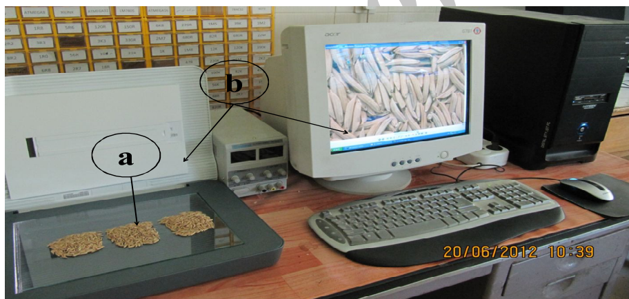
شکل ۳- تصویر برداری نمونه‌ها با استفاده از اسکنر مدل Hp scanjet G3110: (a) نمونه‌ها، (b) سیستم تصویر برداری Fig.3. Imaging of samples using scanner Hp scanjet G3110; (a) Samples, (b) Imaging system
