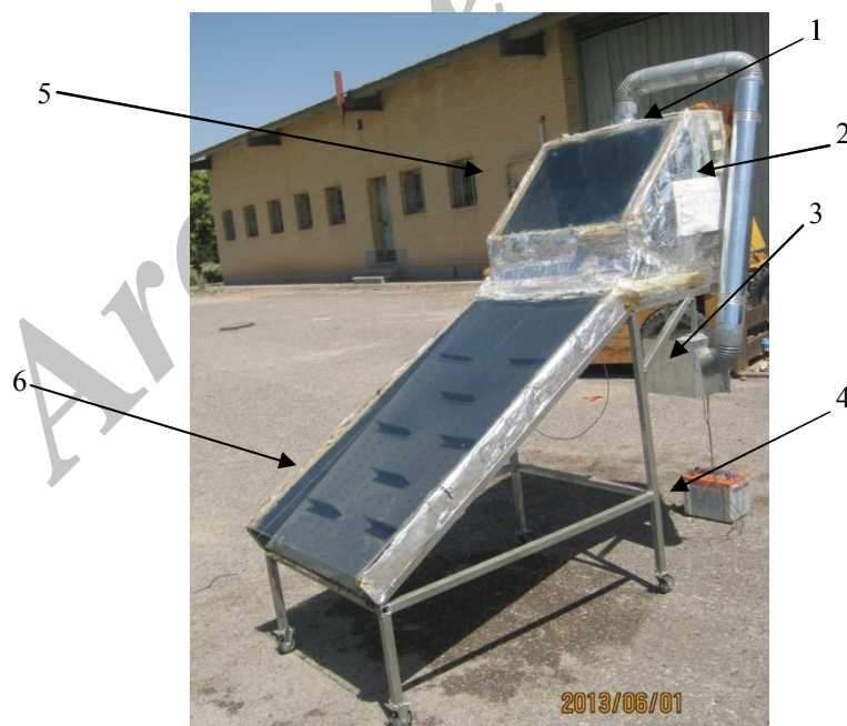
شکل ۱- خشک‌کن خورشیدی مورد استفاده در پژوهش حاضر؛ (۱) محفظه محصول، (۲) کانال خروج هوا از جمع‌کننده، (۳) مکنده، (۴) باتری، (۵) پوشش شیشه‌ای، (۶) جمع‌کننده خورشیدی
