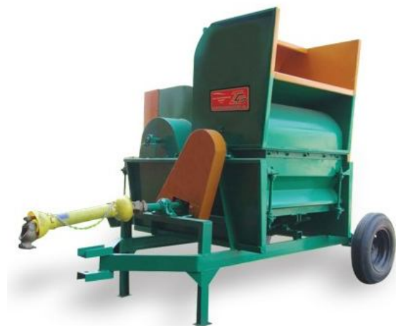
شکل ۱ - نمای خرمکوب چکشی مورد استفاده برای گندم Fig.1. View of hammer thresher was used for wheat grain
