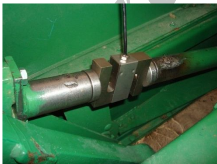
شکل ۱ - بارسنج جایگذاری شده بر روی شاتون پلانجر بسته‌بند Fig.1. The load cell installed on the baler connecting rod
