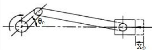
شکل ۴- طرحواره اتصال لنگ و پلانجر دستگاه بسته‌بند Fig.4. Schematic of the crank and plunger in baler
