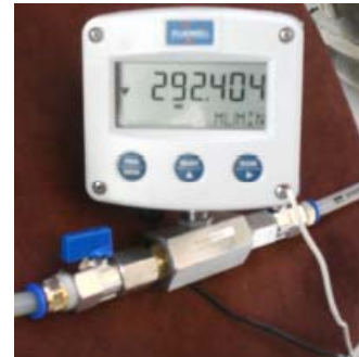
شکل ۳- جریان سنج FTO ساخت شرکت FLOWTECH آمریکا
