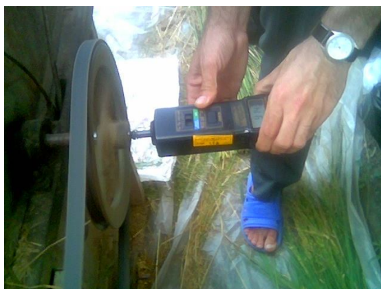
شکل ۱- نحوه اندازه‌گیری سرعت دورانی (rpm) محور کوبنده به کمک دورسنج دیجیتالی Fig.1. Procedure of measurement of drum speed (rpm) by digital tachometer
