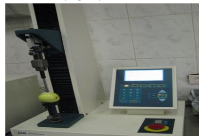
شکل ۳ - دستگاه بافت‌سنج برای اندازه‌گیری بافت میوه با روش مخرب
