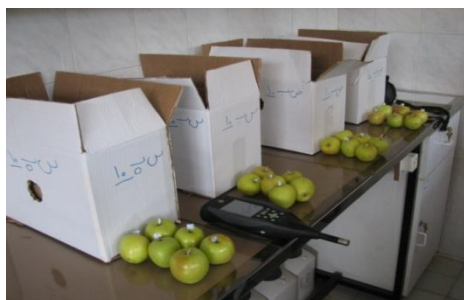
شکل ۲- دستگاه صداسنج جهت ثبت سیگنال‌های ناشی از ضربه‌های غیر مخرب به سیب‌ها
