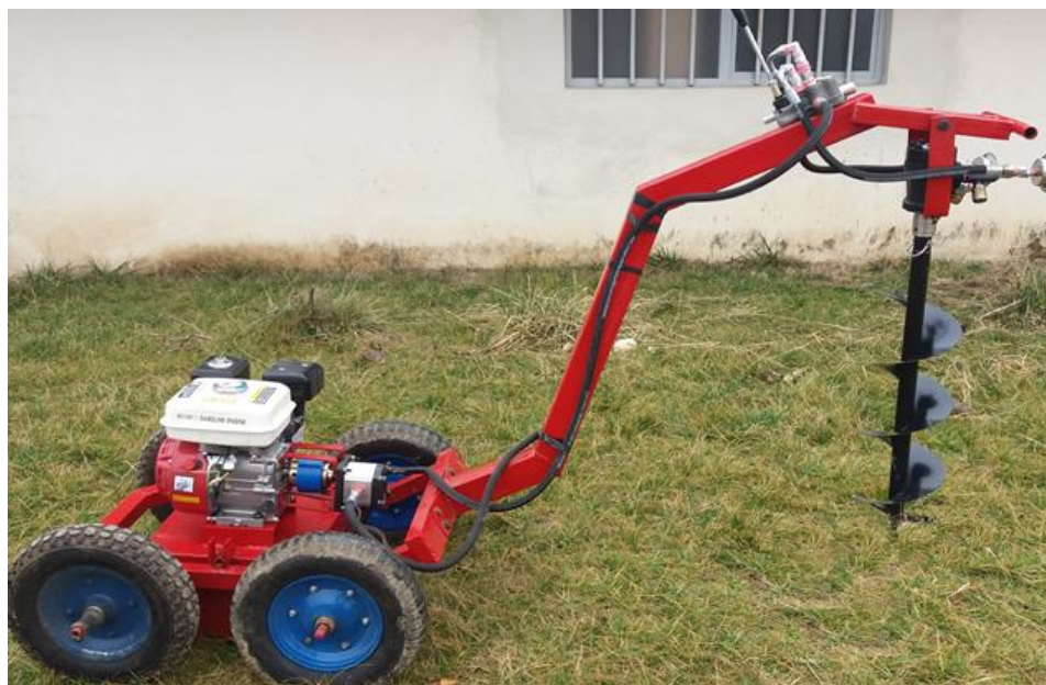
شکل ۴- گودال‌کن هیدرولیکی ساخته شده
